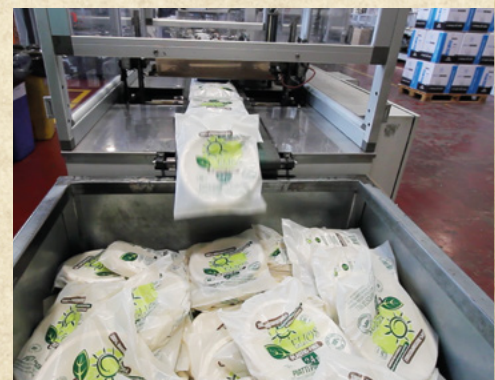
COESTRUSORE E TERMOFORMATRICE IN LINEA PER PIATTI IN BIOCOMPOST
