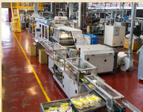
ESTRUSORE E TERMOFORMATRICE IN LINEA PER BICCHIERI IN BIOCOMPOST
