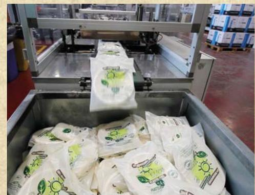
COESTRUSORE E TERMOFORMATRICE IN LINEA PER PIATTI IN BICOMPOST
