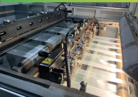
SALDATRICE PER ROTOLI ORTOFRUTTA IN BIOCOMPOST
