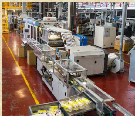
ESTRUSORE E TERMOFORMATRICE IN LINEA PER BICCHIERI IN BIOCOMPOST
